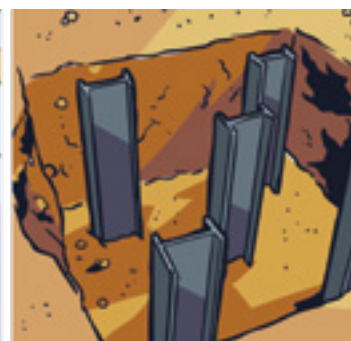
Estacas de perfil soldado
