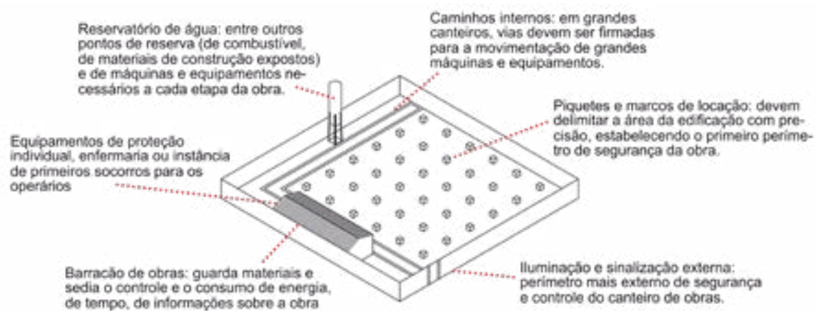
Organização inicial do canteiro de obras
