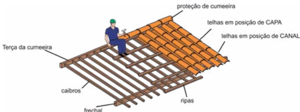
Figura 1.19 – construção de telhado (cobertura)
