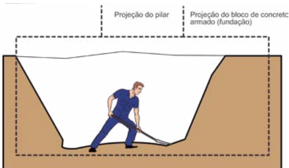
Abertura das cavas e valas de fundação
