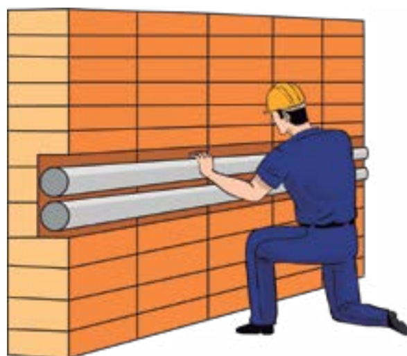
Assentamento e tubulações embutidas em concreto e alvenaria
