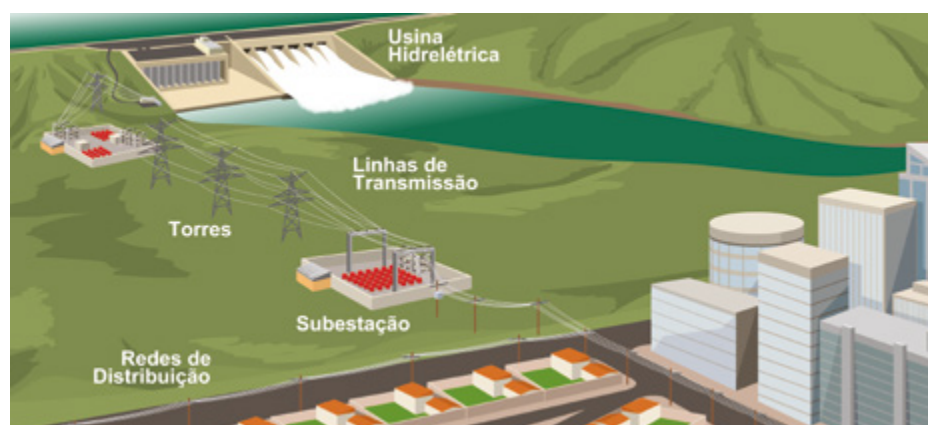
Sistema elétrico de potência (SEP)
